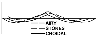
Fig. 4.6.- Comparación entre las soluciones de Airy, Stokes y la teoría Cnoidal (modificada de Komar, 1998).
